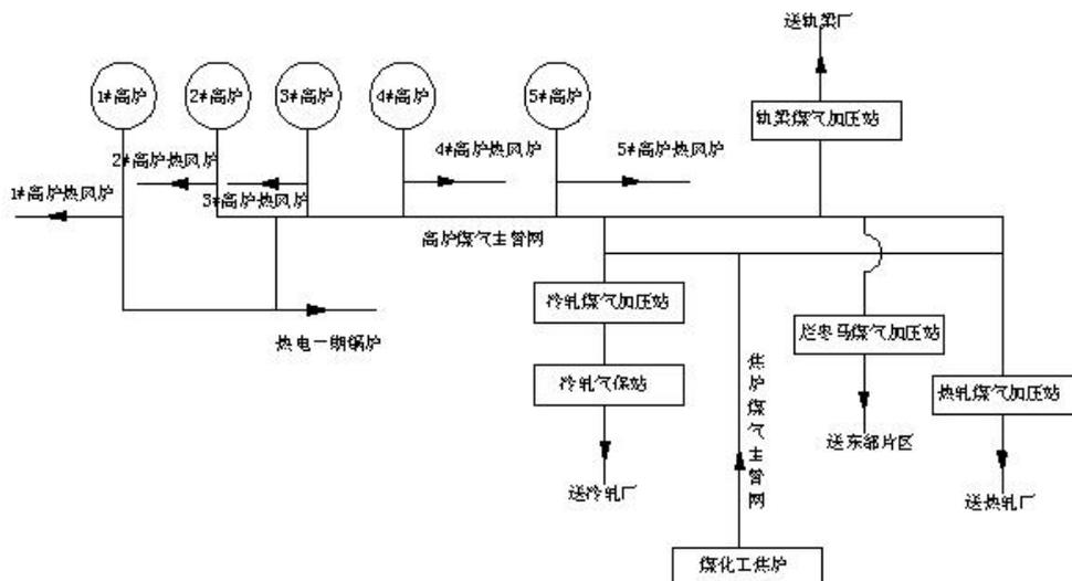
图 4.1-12 燃气系统煤气净化工艺流程图
