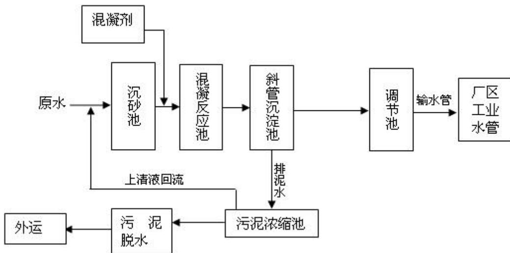
图 4.1-2 取水净化工艺流程图
