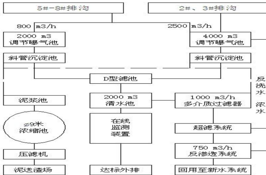
图 4.1-4 钢花污水处理系统工艺流程图
