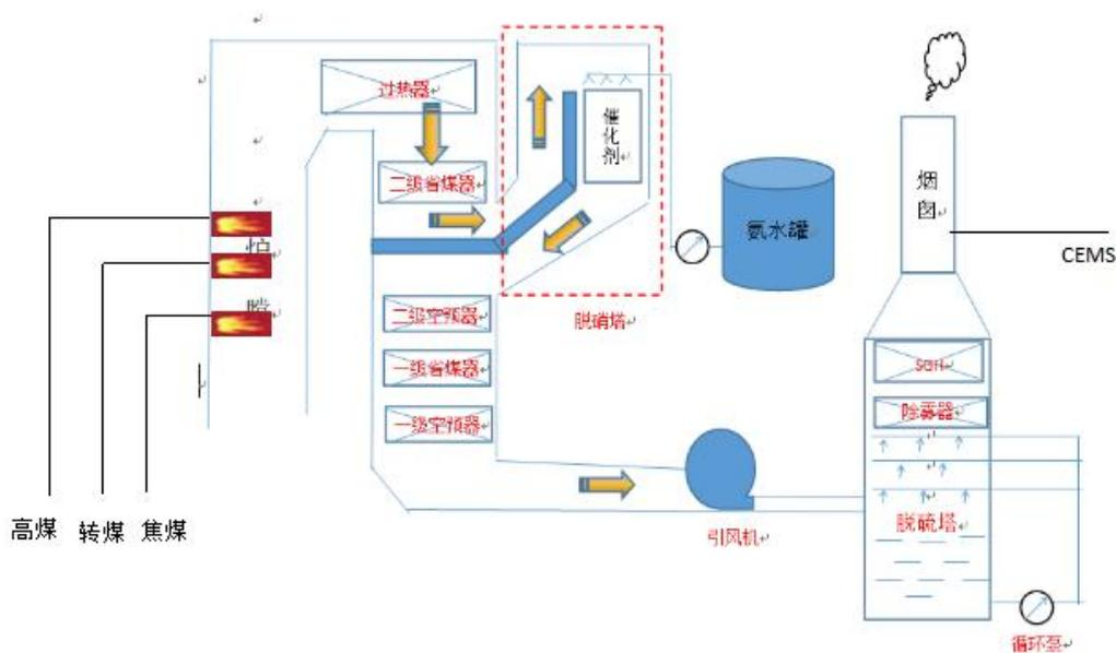
图 4.1-15 1-4#锅炉脱硝工艺流程简图
