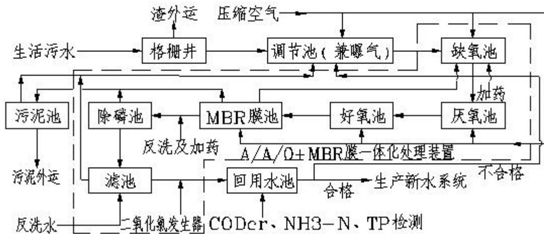
图 4.1-11 西部生活污水处理工艺流程图
