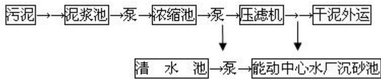
图 4.1-9 污泥处理站工艺流程图
