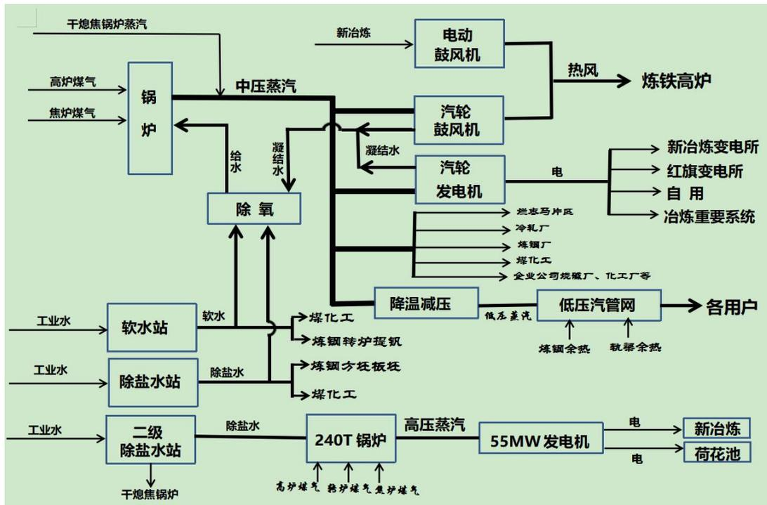
图 4.1-13 热电系统工艺流程
