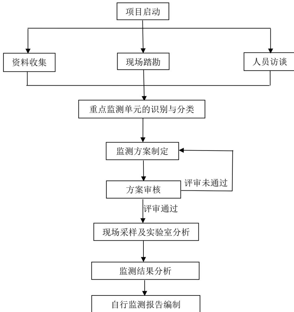
图 1.3-1 土壤和地下水自行监测方案编制技术路线图
