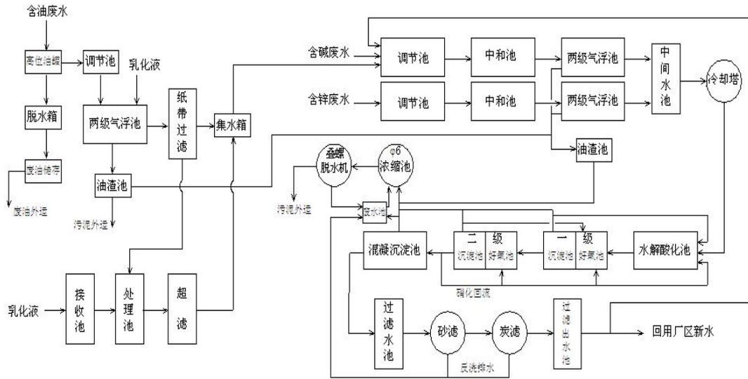
图 4.1-6 含锌、含碱、含油废水处理工艺流程图
