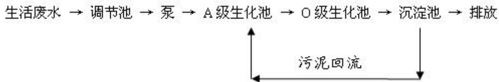
图 4.1-10 生活污水处理工艺流程图
