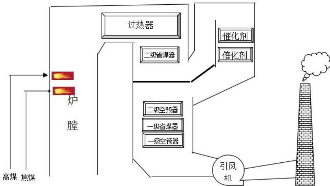
图 4.1-14 240t/h 锅炉脱硫脱硝工艺流程简图
