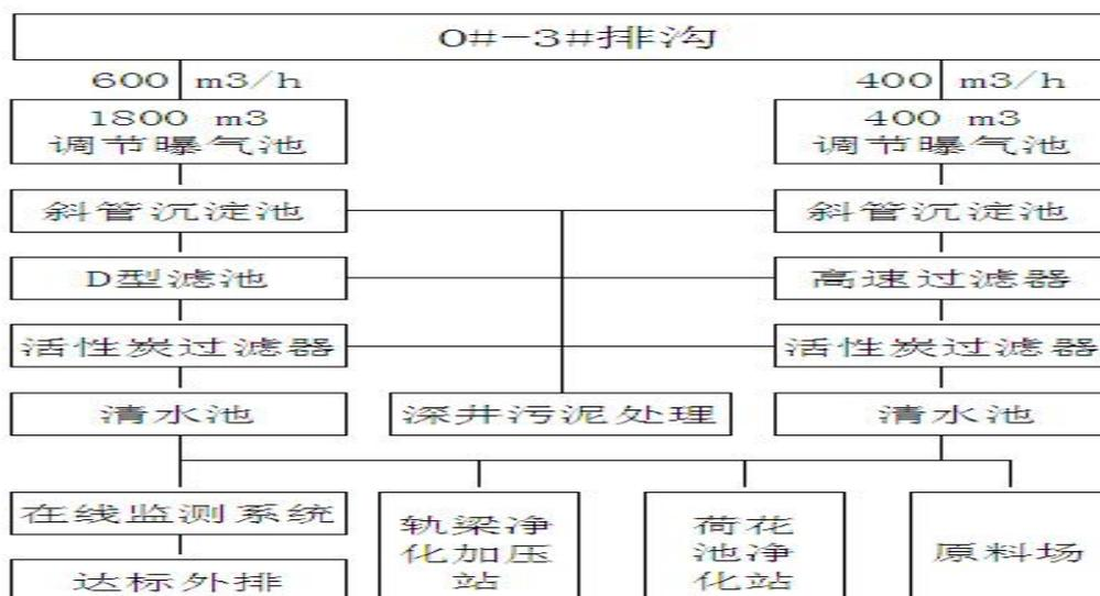
图 4.1-8 工业污水处理站工艺流程图
