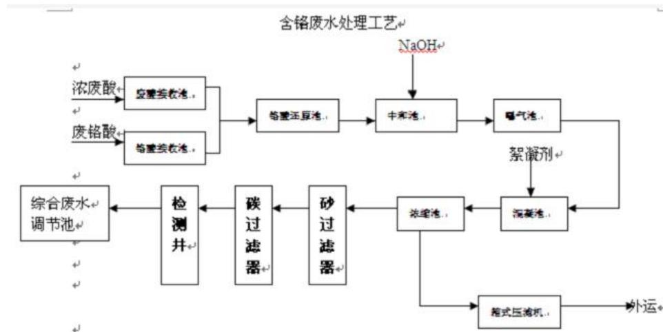
图 4.1-7 冷轧废铬酸处理工艺流程图
